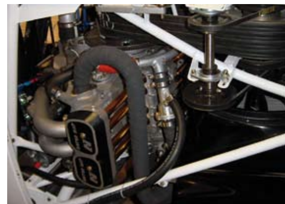
Technischer Leckerbissen mit FADEC RotorWay-Triebwerk RI 162F
